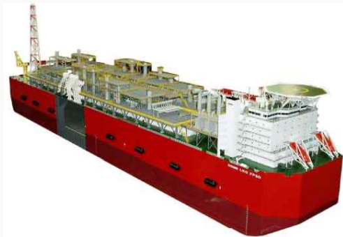
LNG FPSO (Production + Liquefaction)
